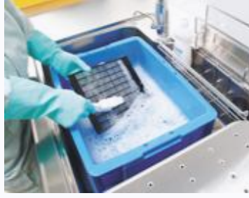
■グリスフィルターの清掃
